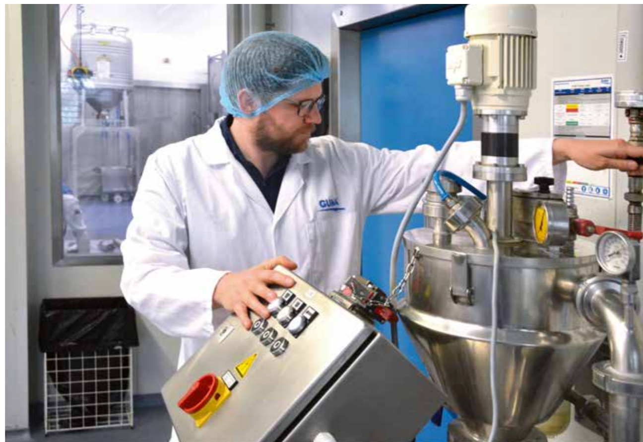
Raphaël kann im Labor mit verkleinerten Versionen der Anlagen die Produktion simulieren.
