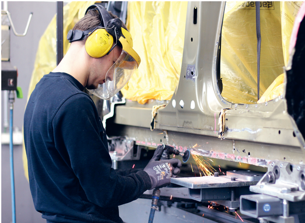
Vor dem Anschweissen der neuen Bleche repariert er die Schäden am Chassis.
