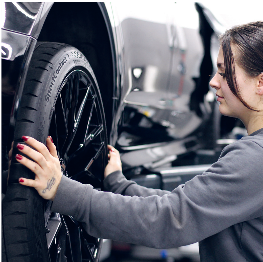
Die Lernende kontrolliert, ob die Räder richtig befestigt sind. Sie dürfen nicht wackeln.
