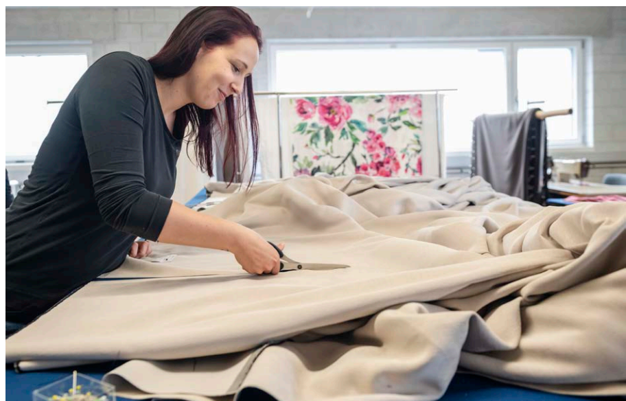
Mit beeindruckendem Tempo schneidet die Wohntextilgestalterin den Vorhangstoff entlang des Verlaufs eines Fadens.
