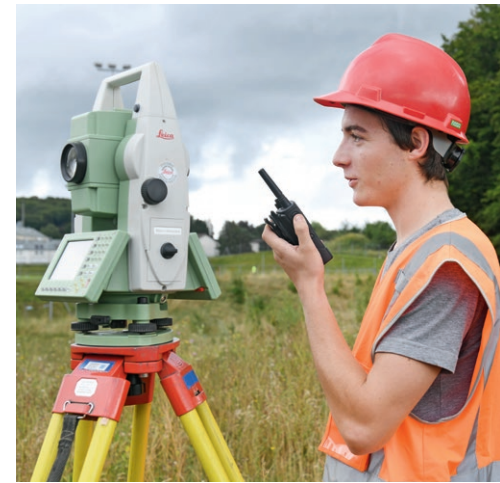
^ Bastien Gay bleibt am Tachymeter stets in Kontakt zu seinem Kollegen mit dem Prismenstab.
