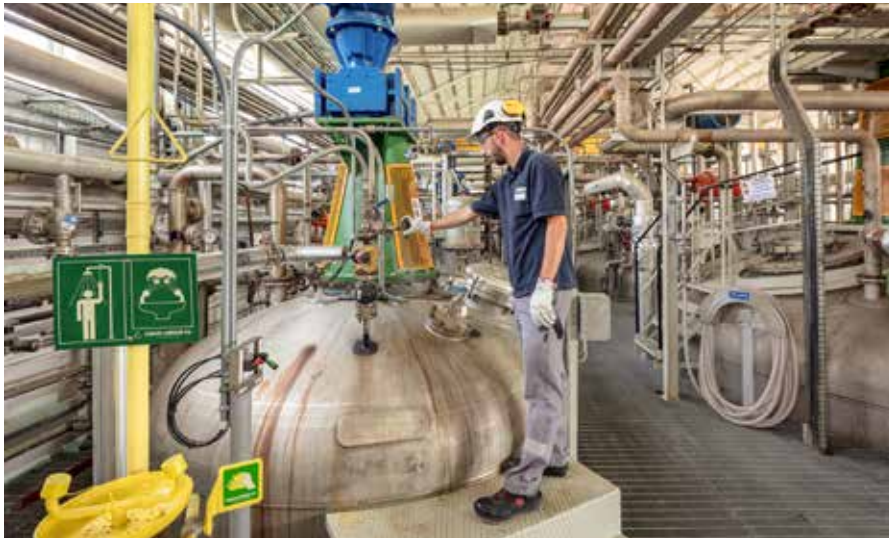
Bei der Novamont-Tochter Mater-Biotech wird Butandiol aus Zuckern von Mais und Sonnenblumen hergestellt. Die Verbindung ist ein Zwischenprodukt der Bioplastik-Produktion.
