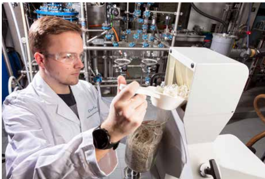
Masterstudent Loïc Habegger füllt Hühnerfedern ins Mahlwerk, um ihr Fett mit einem Enzym zu entfernen. Dann wird das Keratin abgetrennt, aus der Lösung gefiltert und zu Pulver verarbeitet.
