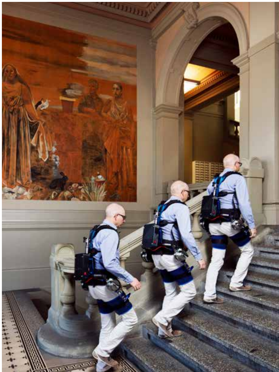
Der Mensch ist noch immer das flexibelste «System» in der Produktion: Das tragbare Exoskelett Robo-Mate kann ihm helfen, Lasten zu tragen und so stark wie mehrere Menschen zu sein. Es wurde in einem von der ZHAW koordinierten EU-Projekt entwickelt.
