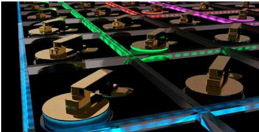
Optisches Netzwerk mit elektrooptomechanischen Schaltern: Je nach Spannung lenken die Schalter einen Lichtstrahl entweder um 90 Grad ab (vorne links) oder lassen ihn ungestört im Wellenleiter passieren (vorne rechts).
