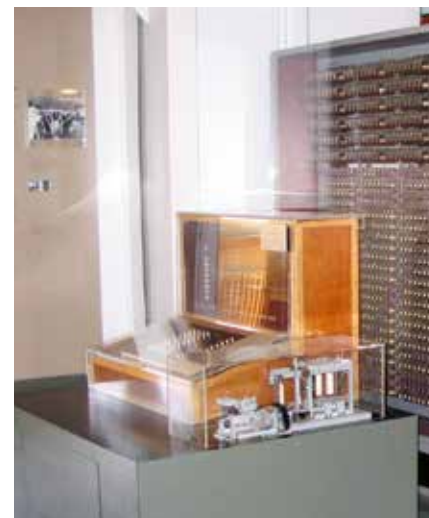
2 Instruktionen pro Sekunde konnte 1941 der erste frei programmierbare Digitalrechner Z3 von Konrad Zuse durchführen. Ein Smartphone schafft heute 70 Milliarden Instruktionen.
