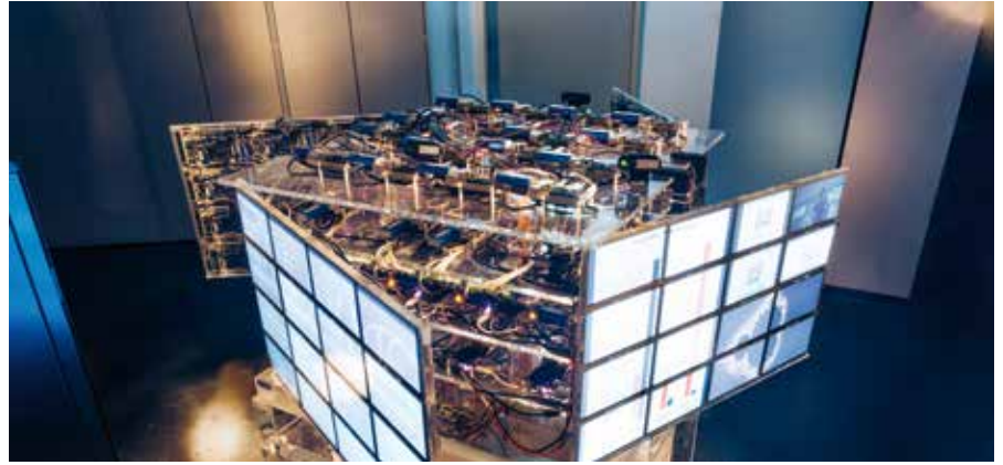
Das \mu -Cluster entstand ursprünglich im Rahmen einer Bachelorarbeit an der Universität Basel und kann parallele Prozesse in der Computertechnik sichtbar und in Echtzeit erlebbar machen.
