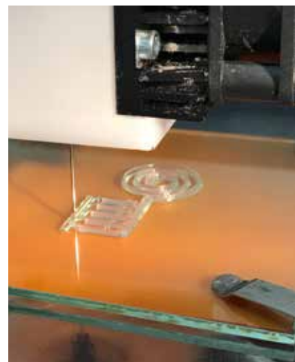
Mit dem 3D-Drucker wird die Nanocellulose-«Tinte» auf eine Trägerplatte appliziert. Silberpartikel sorgen für die elektrische Leitfähigkeit des Materials.
