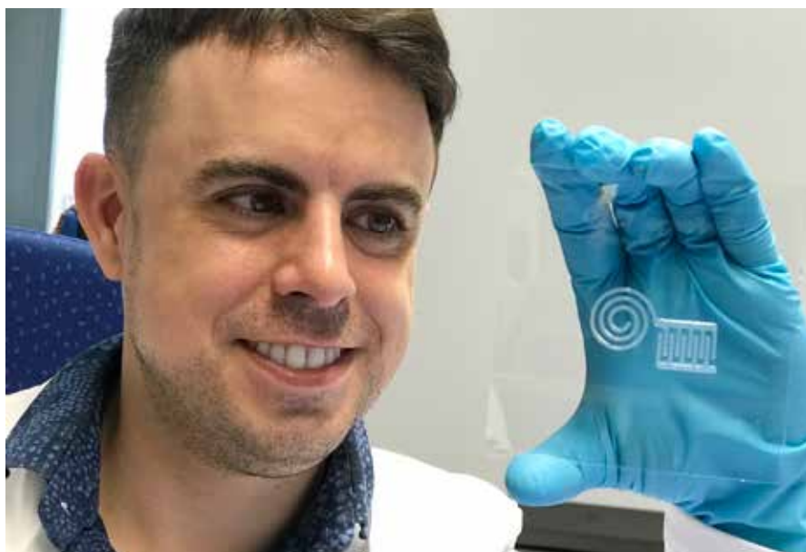
Empa-Forscher Gilberto Siqueira demonstriert den frisch ausgedruckten Nanocellulose-Schaltkreis. Nach einem Trocknungsprozess lässt sich das Material weiterverarbeiten.
