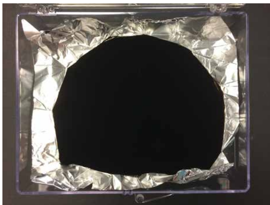
Wie ein Loch im Alu: Vantablack schluckt bis zu 99,96 Prozent des Lichts..
