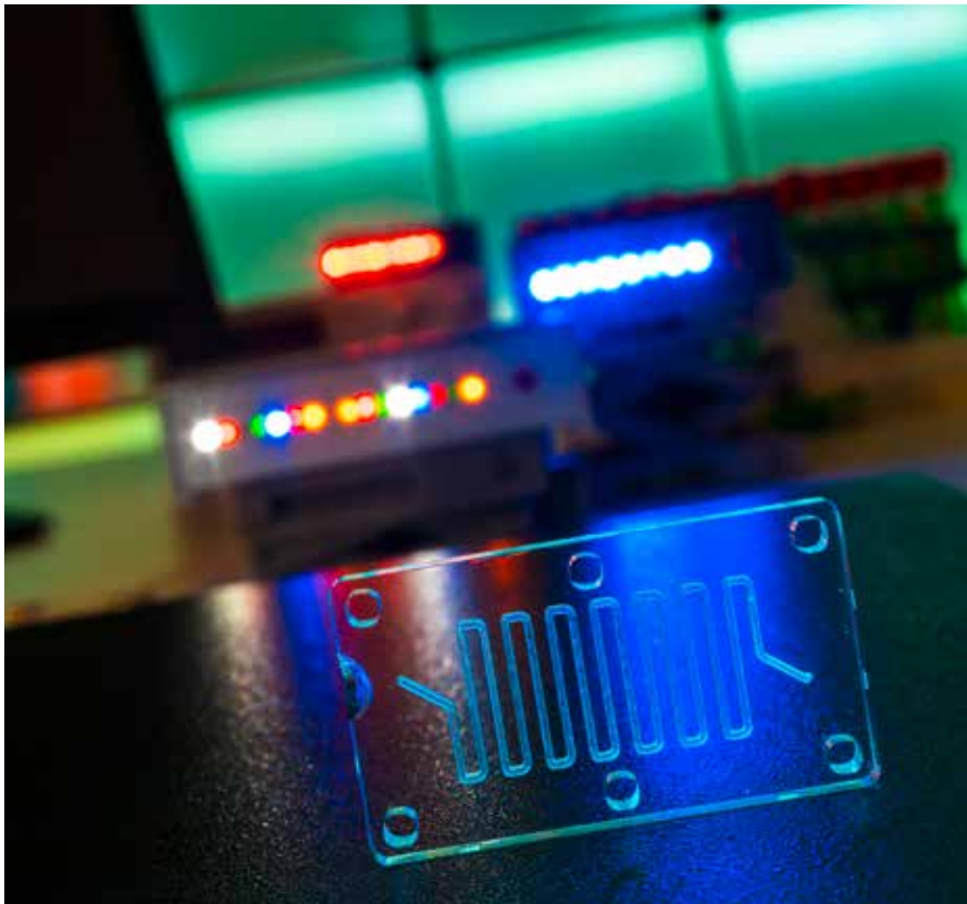
Mikrofluidisches Gerät, das Mikromengen von Flüssigkeit auf einem Mikrochip verwendet, um bestimmte Labortests durchzuführen.
