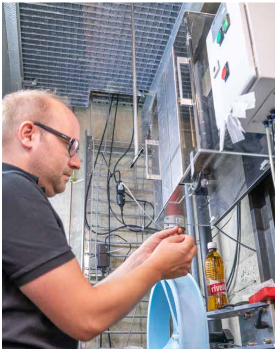
Dr. Sönke Pilz, Physiker, wissenschaftlicher Mitarbeiter, im Ziehturm bei der Glasfaserherstellung.
