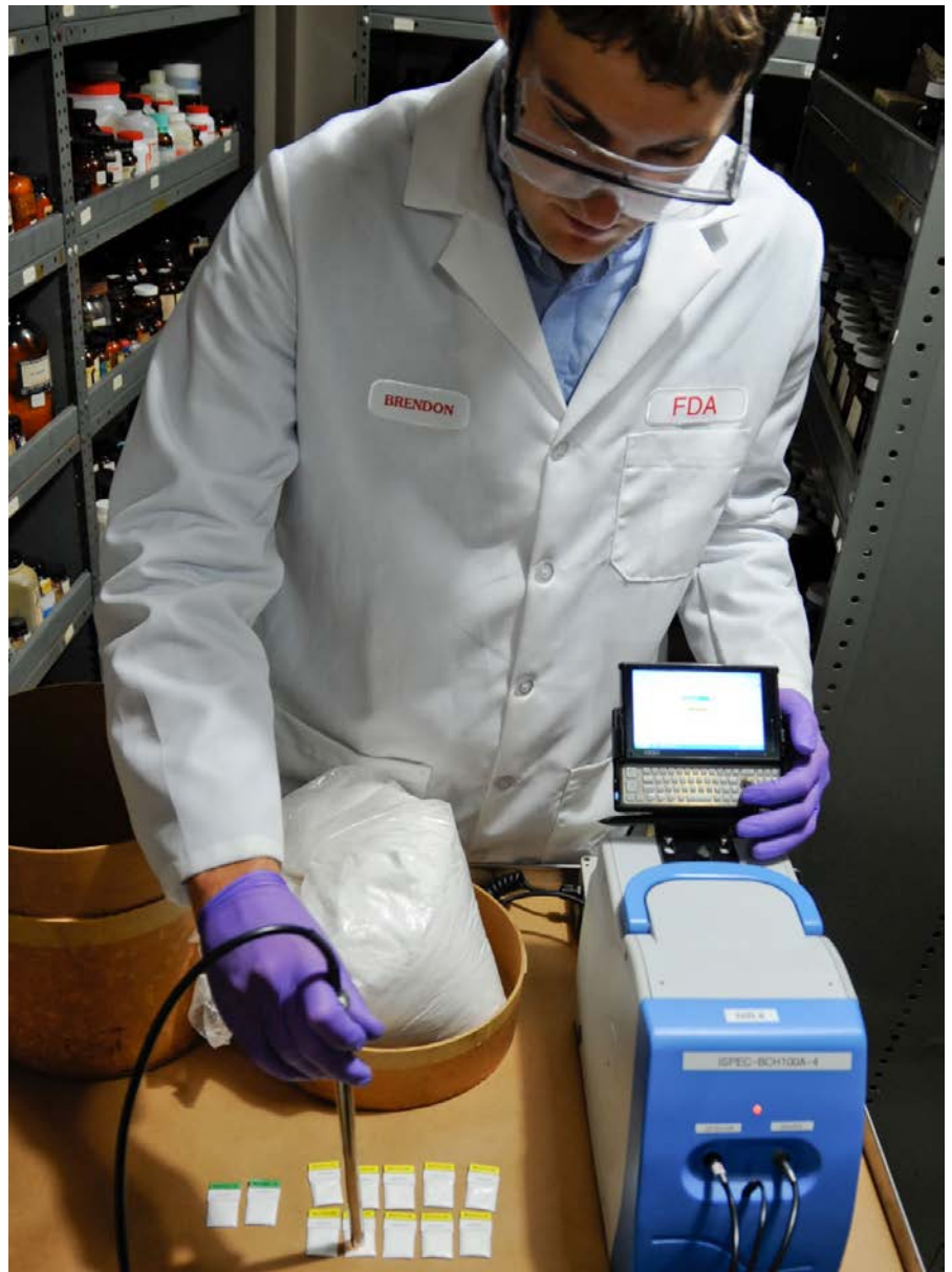
Herstellung und Verwendung von Arzneimitteln unterliegen strengen gesetzlichen Vorgaben. Ein Inspektor kontrolliert Heilmittelproben mithilfe eines tragbaren Scangeräts.
