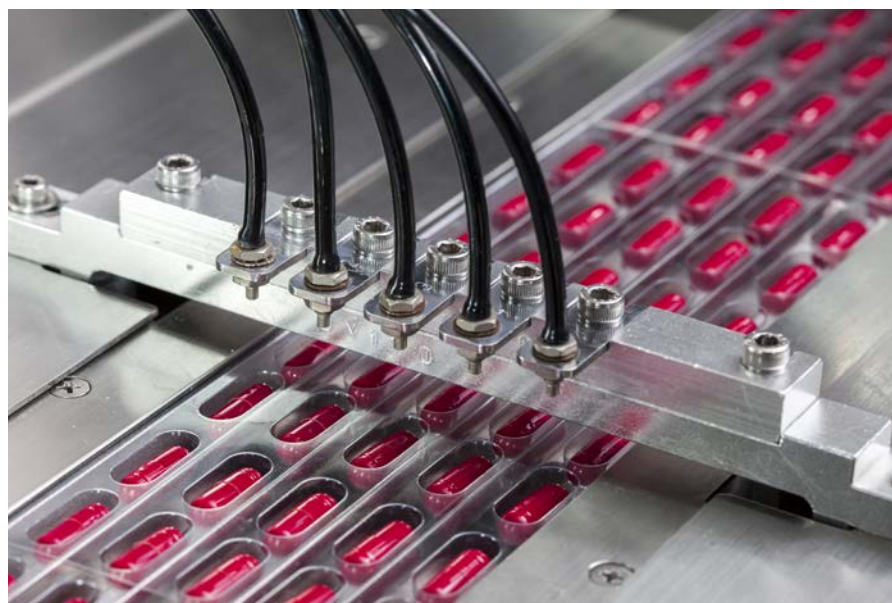
Pharmatechnologie beschäftigt sich mit der Entwicklung, industriellen Herstellung, Zulassung und Qualitätskontrolle von Fertigarzneimitteln. Im Bild ein Verpackungsprozess für Hartgelatine kapseln.+
