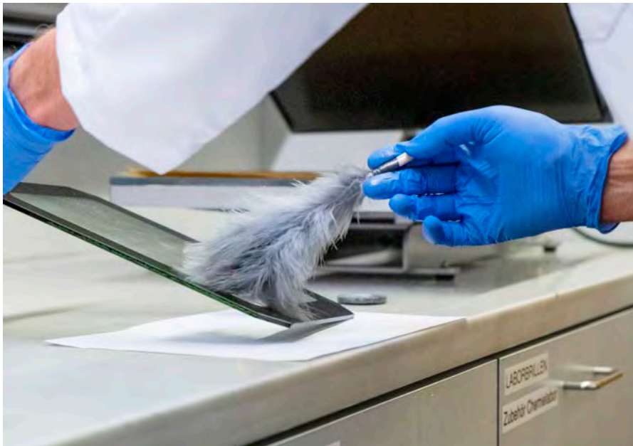
Mit einem Marabu-Pinsel wischt der Kriminaltechniker überschüssiges Pulver von der Glasfläche.
