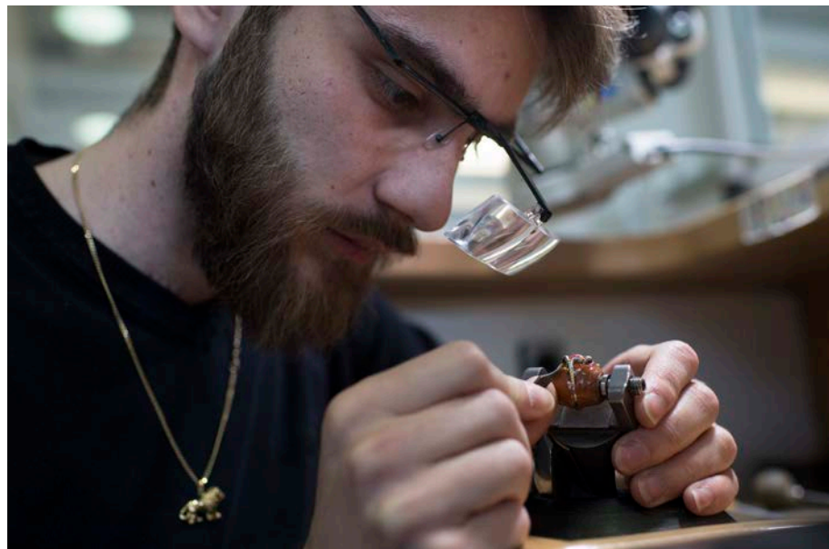
^ Mit farbigen Punkten teilt Sandro Ambord das Schmuckstück ein. Jede Farbe steht für eine andere Steingrösse und markiert den Ort, wo später ein Edelstein platziert wird.
