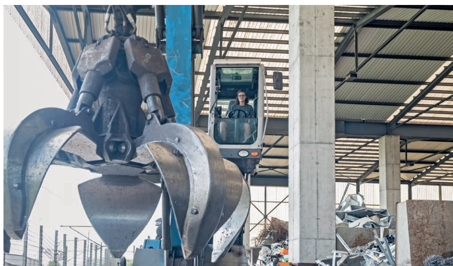
↗ Hohe Position: Die Recyclistin verfrachtet mit Hilfe eines Greifbaggers Altmetall in einen Eisenbahnwagen.
