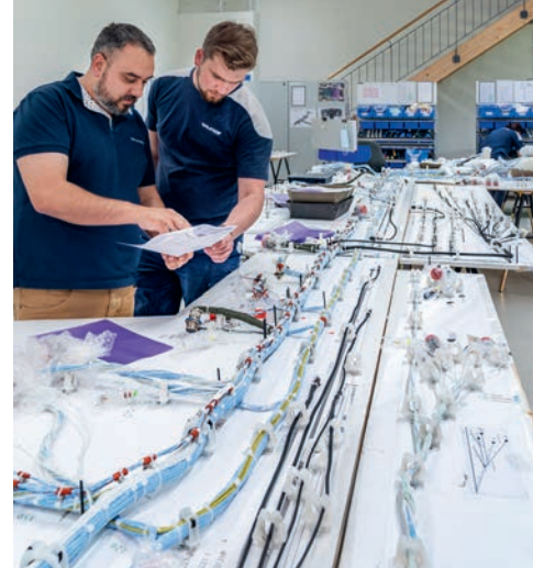
^ In den Werkstätten bündeln die Automatikmonteurinnen und Automatikmonteure die vielen Kabel.
