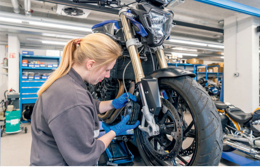
◀ Jennifer von Büren montiert die Bremsanlage neu.
