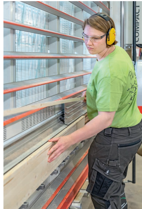
✔ Jasmin König nutzt eine Plattensäge, um grosse Holzplatten präzise zuzuschneiden.
