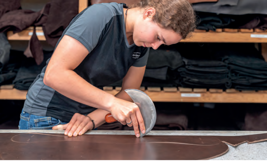
◀ Sandra Eugster schneidet mit dem Halbmond die Rohform eines künftigen Sattelgurts aus einem Kuhlederstück.
