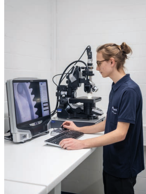
↗ Mithilfe von diversen Messgeräten überprüft Cédric Bernet die Qualität eines Kunststoff-Zahnrads.
