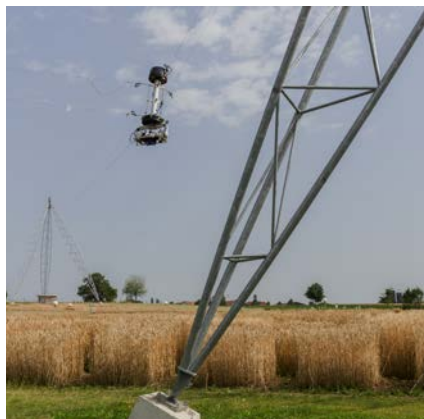
Die FIP in Aktion: Der Sensorkopf kann sich direkt über den einzelnen Plots positionieren, um die Eigenschaften jeder Weizensorte zu dokumentieren.
