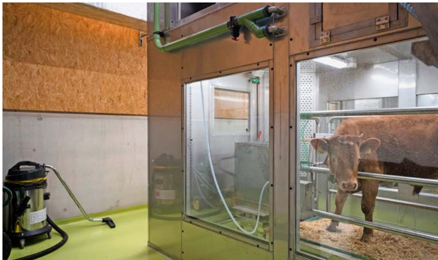
Bei dem jungen Muni werden sowohl die Atemgase als auch das Methan aus dem Verdauungstrakt 48 Stunden lang in der Respirationsskammer gemessen.
