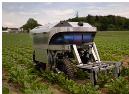
Der Roboter «Rowesys» entfernt das Unkraut zwischen den Reihen mit einem vierzinkigen Grubber.
