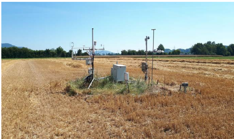
Forschungsstation Oensingen mit der Eddy-Kovarianz-Messstation: In rund 20-jähriger Beobachtung konnte die ETH nachweisen, dass der untersuchte Acker mehr CO 2 verliert als er aufnimmt, er also eine langfristige Kohlenstoffquelle ist.
