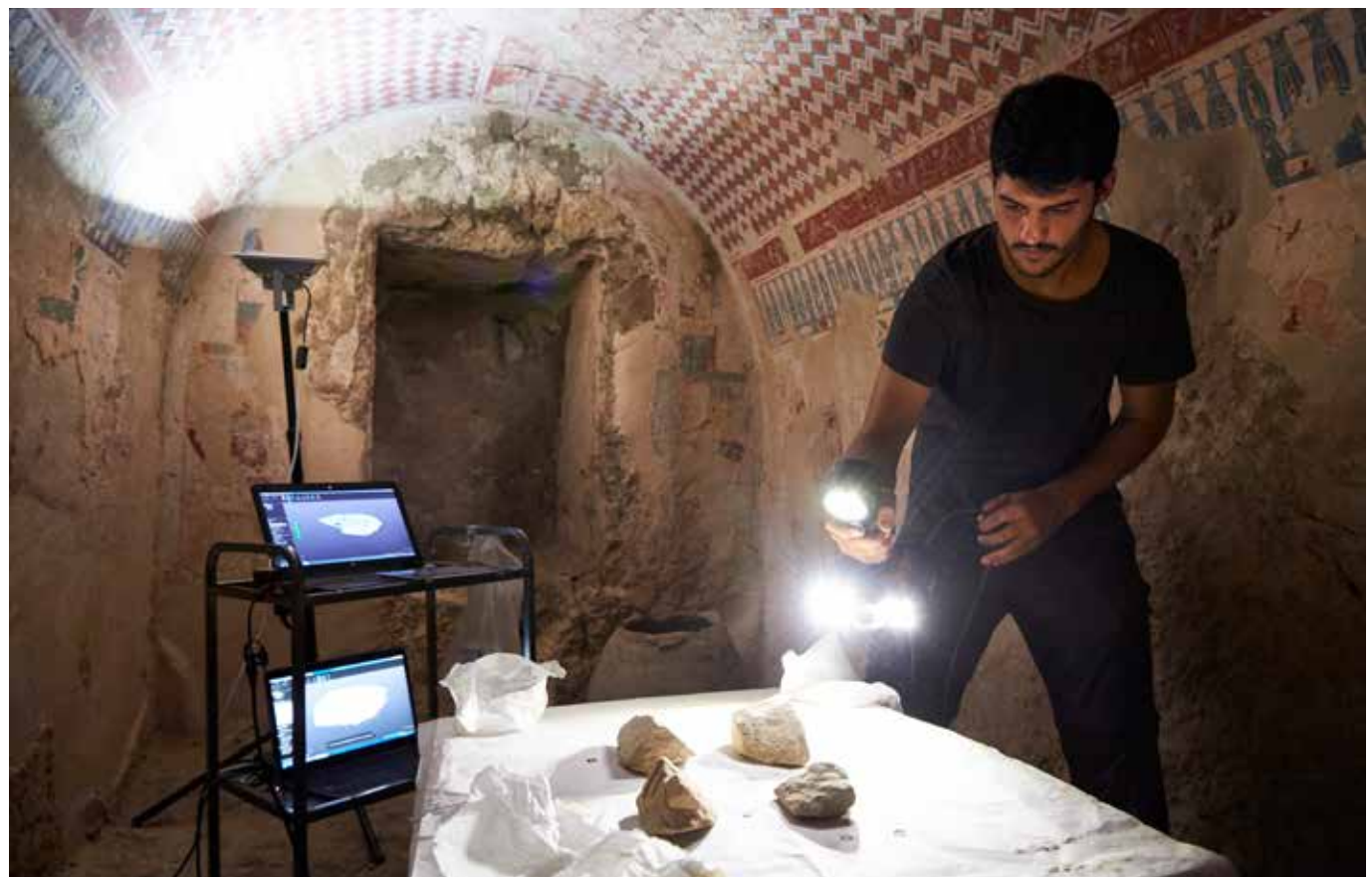
Die Archäologischen Institute führen ihre eigenen Ausgrabungsprojekte durch. Hier werden mit einem Handscanner mit strukturiertem Licht 3D-Scans von Sandsteinfragmenten gemacht.
