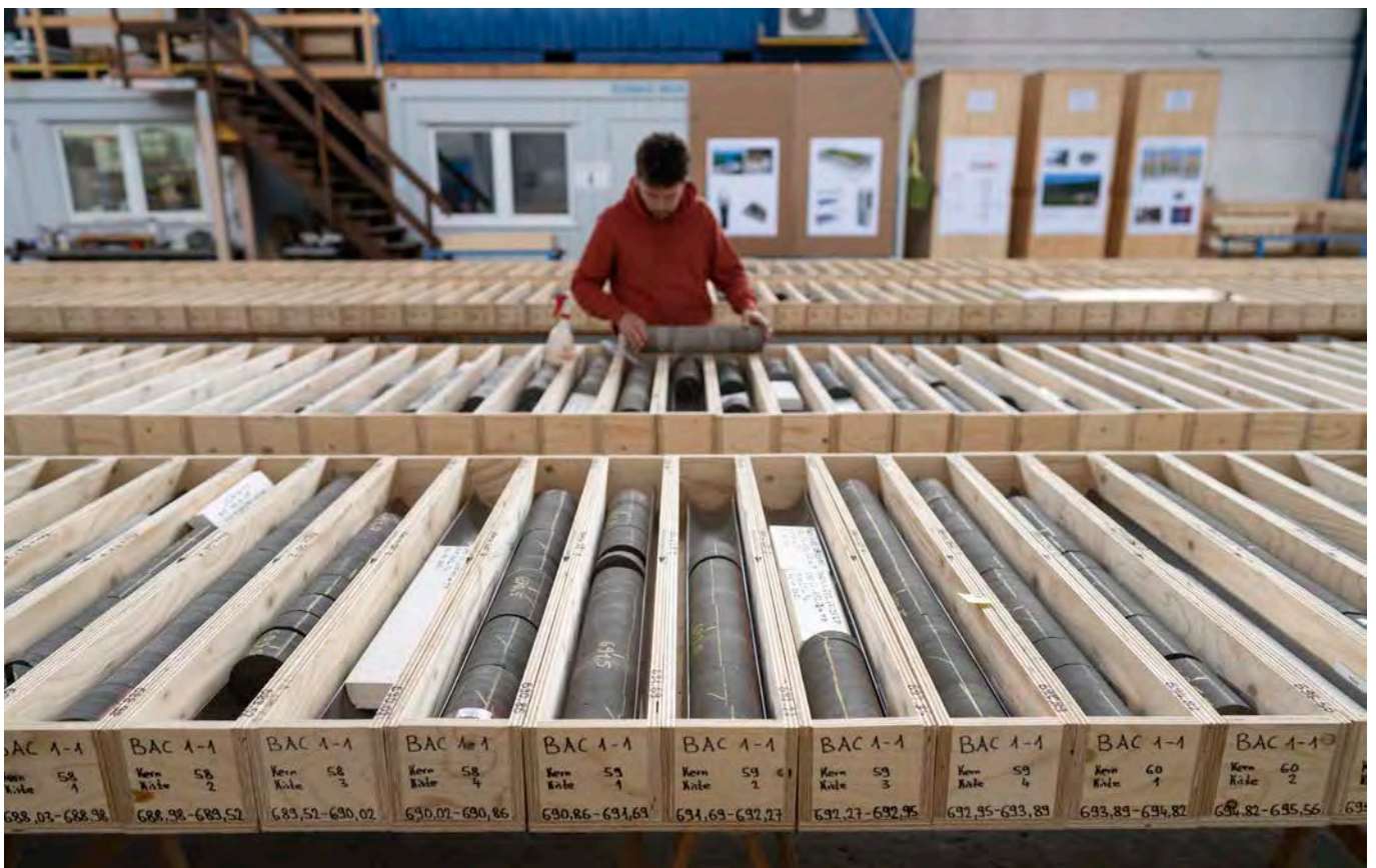
Seit Dezember 2018 betreibt die Nationale Genossenschaft für die Lagerung Radioaktiver Abfälle Nagra in Würenlingen (AG) ein Kernzwischenlager. Rund 1000 Kisten mit je ein Meter langen Bohrkernen (Gesteinsproben) aus verschiedenen Tiefbohrungen liegen im Kernzwischenlager und werden durch einen Geologen charakterisiert.
