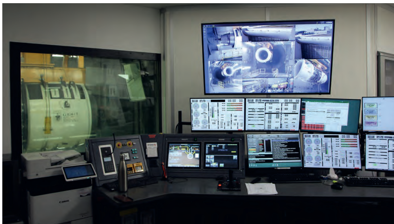
Im Kontrollzentrum des Triebwerk-Prüfstands von SR-Technics: Hier wird die Abgassonde des Messsystems SMARTEMIS gesteuert, welches Daten zum Emissionsverhalten älterer Triebwerke sammelt. Bisher basierten Angaben dazu lediglich auf Schätzungen.
