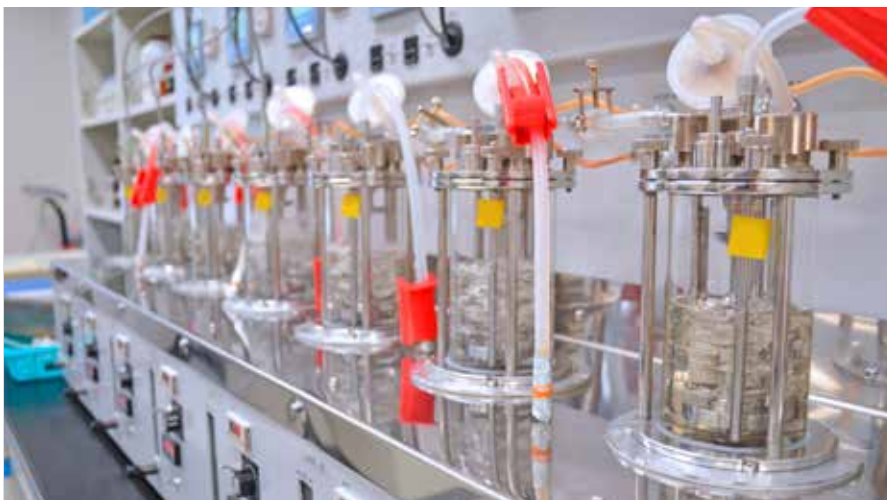
Bioreaktoren sind Behälter, in denen eine Biomasse (Mikroorganismen, Zellen oder kleine Pflanzen) unter möglichst optimalen Bedingungen betreffend pH-Wert, Temperatur und Sauerstoffgehalt in einem flüssigen Nährmedium kultiviert oder fermentiert wird.
