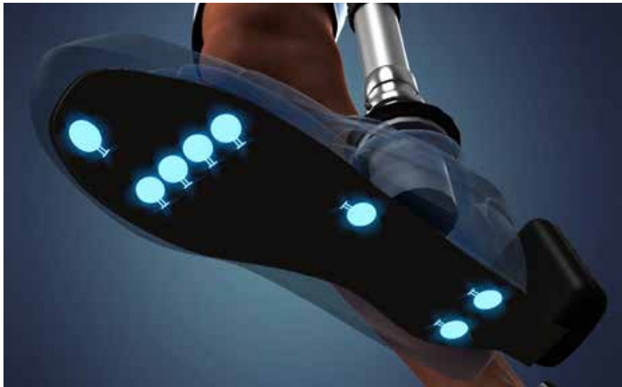
Signale von Tastsensoren unter der Fußsohle sowie von Winkelsensoren im elektronischen Prothesen-Kniegelenk werden bei dieser neuartigen Prothese an das Nervensystem weitergeleitet.
