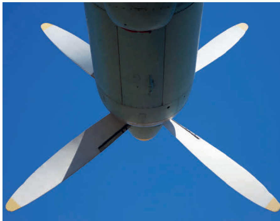
Bei «normalen» Propellern sind die Blätter gleichmässig verteilt.
