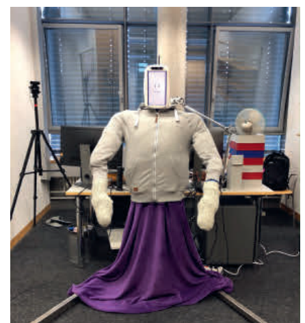
Ein Umarmungsroboter muss weich und warm sein, die Grösse eines Menschen haben und das Gegenüber erkennen.
