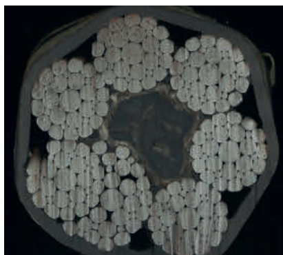
Querschnitt durch ein Seilbahnseil beim Spleiss.
