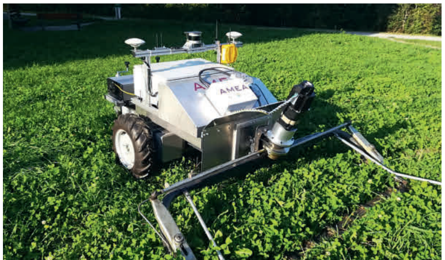
Der Mähroboter soll vor allem auch an Hanglagen mähen können. Später soll er dazu fähig sein, autonom Heu zu schieben, zu mulchen, zu düngen, Strassen zu reinigen oder Schnee zu räumen.
