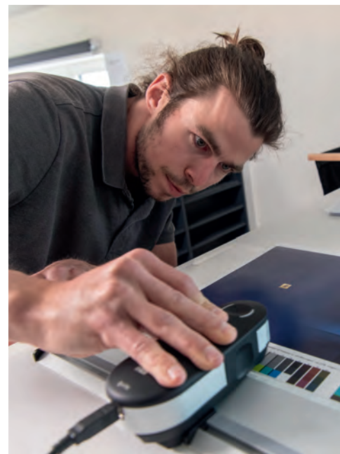
^ Charles Hänni prüft die Qualität des Drucks mit einem Farbmessgerät.
