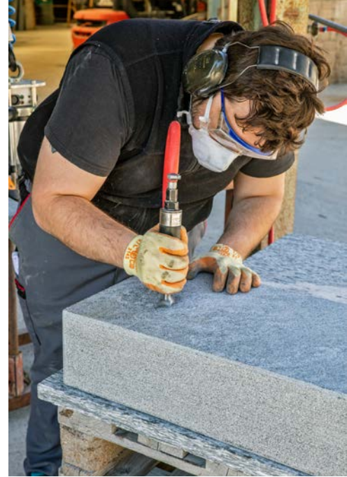
^ Mit dem Druckluft-Stockhammer verleiht Raul Pollini der Oberfläche des Steins eine spezielle, raue Struktur.
