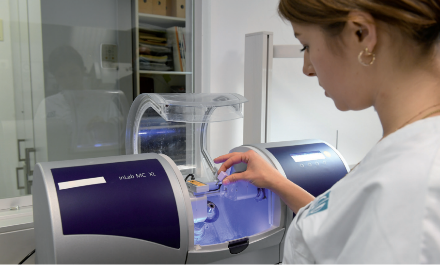
◀ Die Lernende schleift eine Krone mit der Fräsmaschine.
