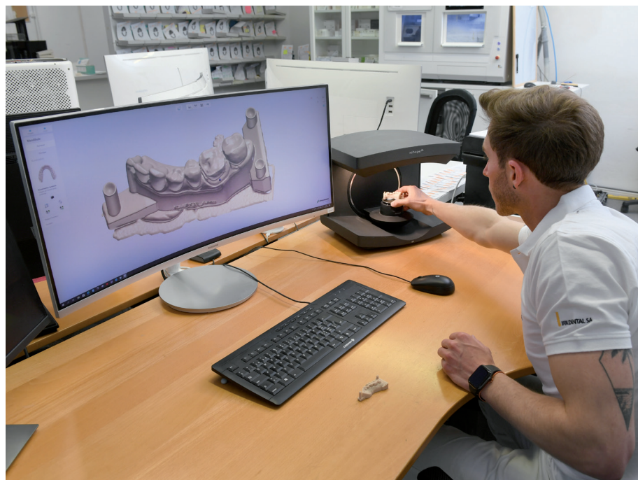
^ Zahnabdrücke können mithilfe eines 3D-Scanners digitalisiert werden.
